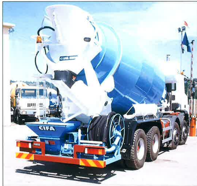
L'azionamento è effettuato tramite una presa di forza al cambio dell'autotelaio.
