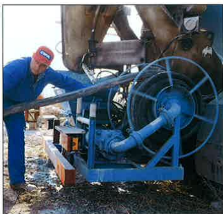
L'unità è dotata di un tubo in gomma leggero e maneggevole, lungo 40 m, posizionato su un avvolgitore idraulico.
