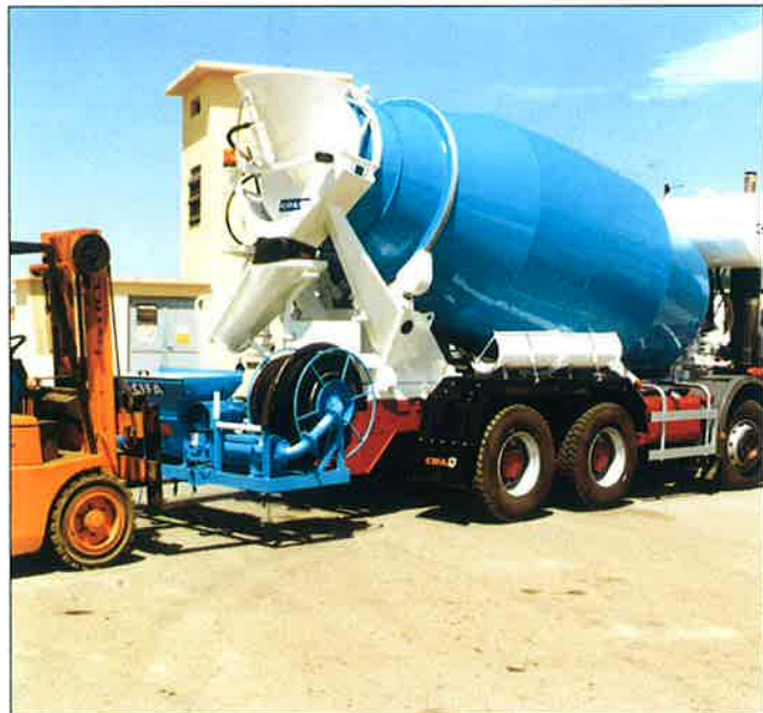
La pompa può essere scarrata in pochi minuti per mezzo di un semplice muletto.
