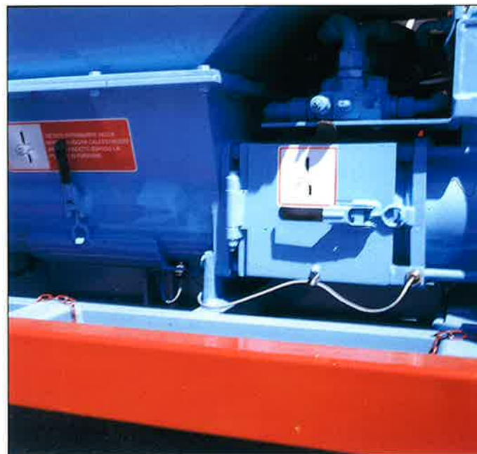
Portelle di ispezione e lavaggio dotate di fine corsa di sicurezza.
