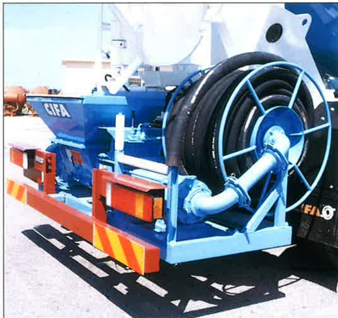
La pompa è alloggiata sulla barra paraincastro posteriore, sotto la canale di scarico.
