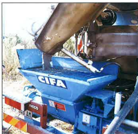
Alimentazione tramoggia. La tramoggia di convogliamento può essere alimentata anche da più di una autobetoniera.
