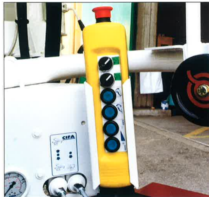
Comandi autobetoniera e pompa per il polistirolo.
